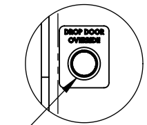
AUTO DOOR PUSH BUTTON SWITCH DETAIL A SCALE 1 : 4
